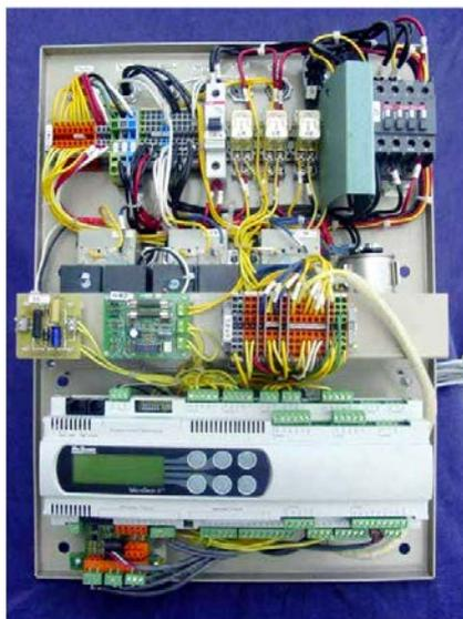
图 9-5 Microtech II 压缩机控制器
