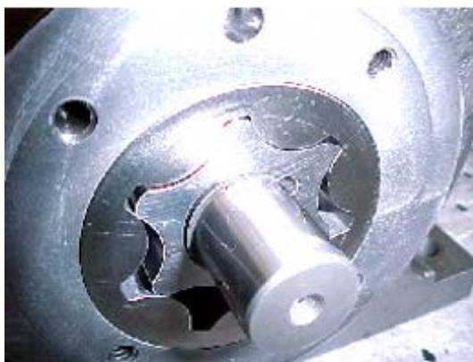
图 12-3 油泵压缩部件
