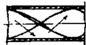
图 2.9 内插扭带对流动方向的改变
