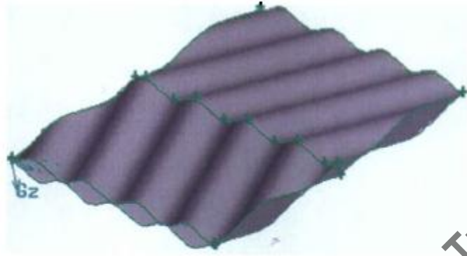
图 3.11 人字形斜波纹模型
