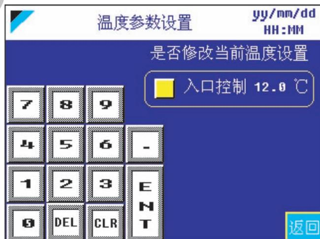
操作：先按下绿色方形按钮开关，激活温度设定光标，然后输入设定值，再按“ENT”键，再按一下绿色方形按钮开关使之复位。同时 [ 温度参数设置 ] 画面和 [ 运转状态 3 ] 画面相应温度显示值也跟随发生变化。
