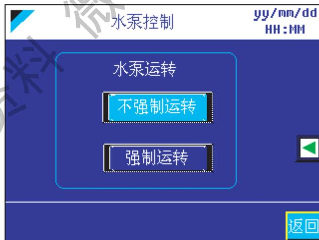
强制运转：只要给机组提供控制电源，控制水泵运转继电器将动作。
