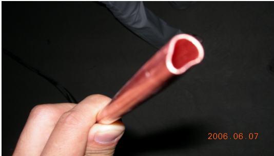
使用的铜管管壁厚度不够，施工时容易变形，承受不了系统压力（差）
