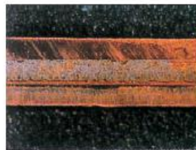
阻塞区 由灰尘引起的毛细管阻塞
