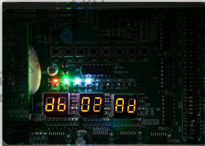
**特别提醒：**此步骤过程中所有按键无效，1min内可通过调试软件设定主内机；若1min内没有设定，则系统将自动随机设定主内机（此时状态代号显示L7）。后续可通过功能设定重新更改主内机设置。
