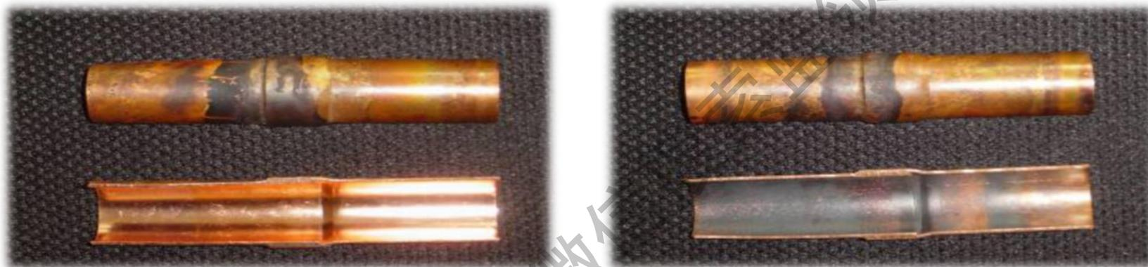
钎焊时未进行充氮保护或没有充入足量的氮气，铜管内表面就会产生氧化物，会造成：
