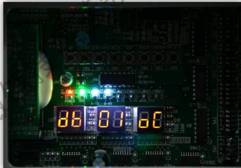
**特别提醒：**db代表系统处于**调试状态**；01代表**调试进度**（第一步）；0C代表调试**运行状态**正常。如显示CC则代表无主模块，CF代表主模块重复。
