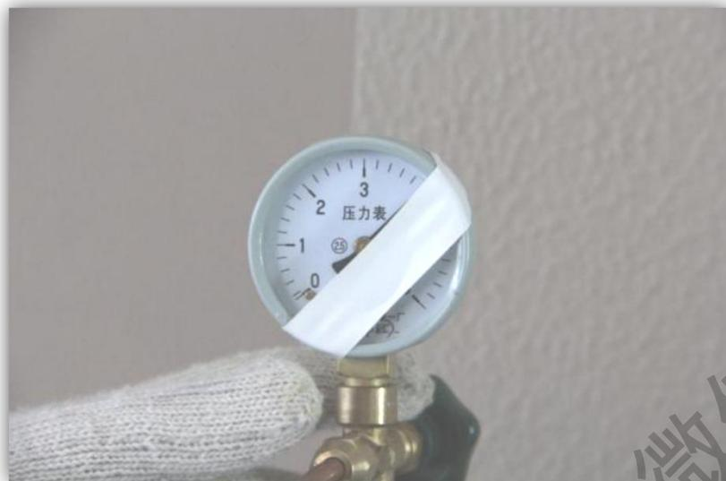
记下充氮时的时间、温度和充入的压力（可用左图贴白胶带的方法进行对比），以便24小时后进行修正。
