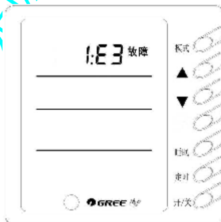
图 4 故障代码显示
