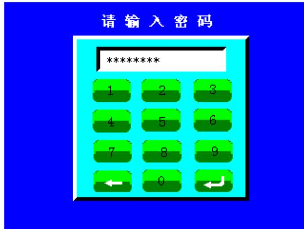
密码输入框画面：用于用户的密码输入，当输入正确的密码后，才能进入有关的项目设置、功能设定等；误输入按“←”按钮退格删除；“↵”按钮确定。
