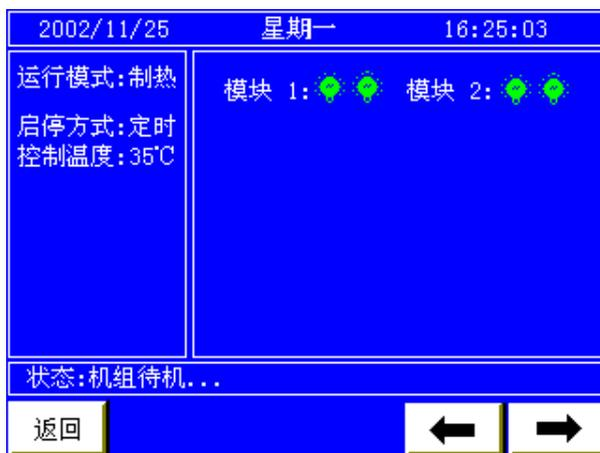
状态查询画面：显示机组当前温度、设定温度、启停方式以及输出状态（灯亮表示已输出，灯灭表示停止输出）等。按右下角按钮可查询单个模块的信息，包括每个模块的所有输入输出状态。按下输入查询时，显示该模块的开关量的状态，再按一次返回到模块状态查询画面，按下输出查询时，显示该模块的继电器输出状态。
