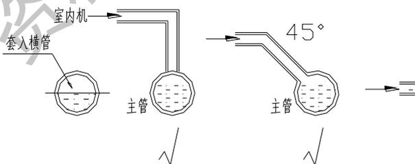
4) 水平支管与竖直主管的连接，应保证来自竖直主管上部的冷凝水不会倒灌入水平支管内;
