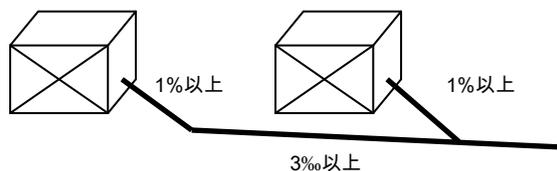
2) 冷凝排水管汇流时禁止出现相向对流的情况;
