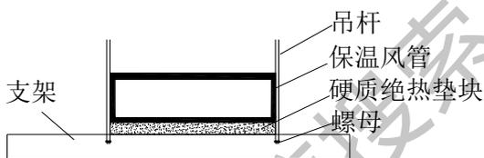
9) 风管法兰处应加设保温板，如下图，是为了防止法兰处形成冷桥而凝露。
