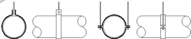
10) 风管安装后，支、吊架受力应均匀，且无明显变形，吊架的横担挠度应小于9mm。
