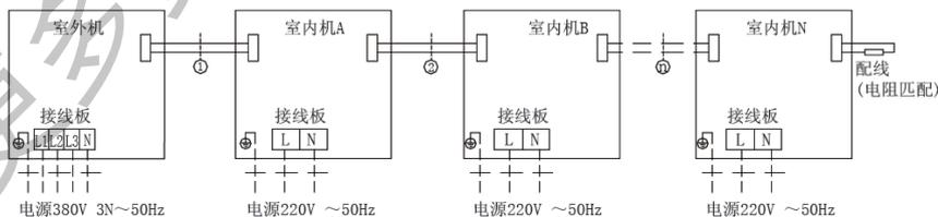
2) 45kW以上非模块化室外机及室内机的外部接线示意图
