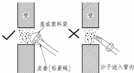
2) 管道穿过的外墙孔必须密封，并应向室外倾斜向下，雨水不得渗入。
