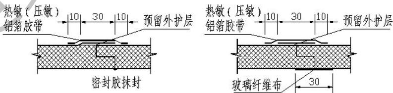
5.7.4. 风管管板槽口形式可采用45°角形和90°梯形。切割槽口应选用专用刀具，且不得破坏铝箔表层。组合风管的封口处宜留有大于35mm的外表面搭接边量。
