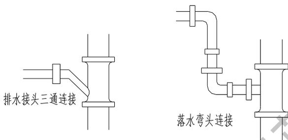
5) 冷凝排水管应单独设置，严禁接入污水管、粪水管、雨水管等其他管道。避免异味进入室内、雨水倒灌的情况发生；
