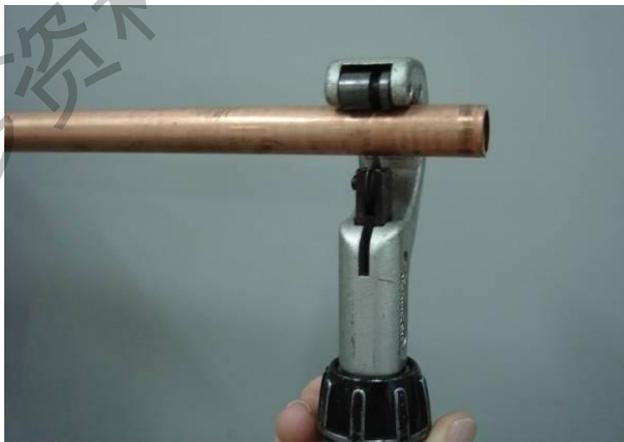
2) 操作时应该缓慢地加紧切管器、缓慢地转动、在铜管不发生变形的情况下切断铜管。若管端明显变形时，将其切断并扔掉，重新加工。
