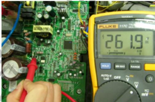
主板断电后的高压残电
