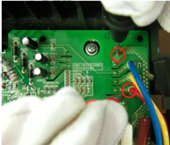
**注：**各外机控制器关键电源测试点基本相同，主要有直流母线300V、IPM15V、IC2003、继电器12V、芯片5V、主芯片3.3V。本章测试点以主流谦者（新凉之静、新变频金刚）、新分体变频控制器为例，其余控制器测试点与此相似。
