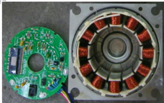
无刷直流电机内置驱动板及定子
