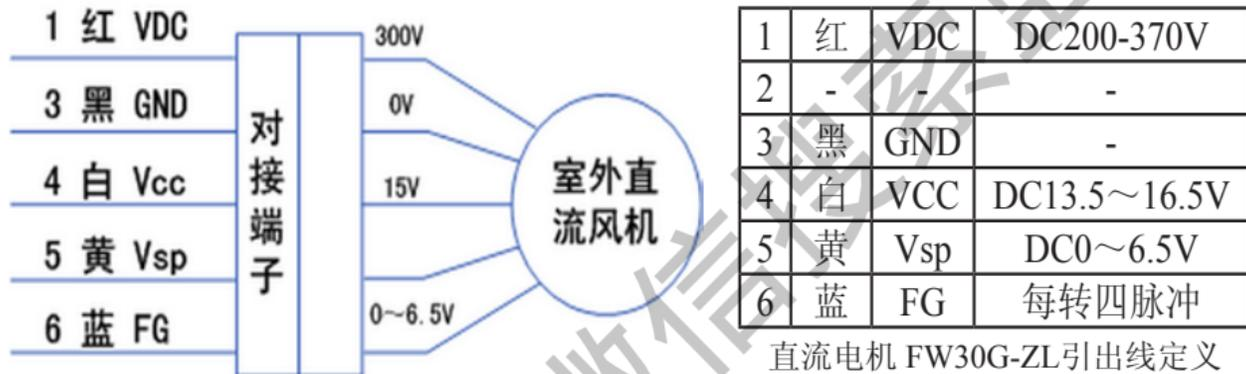
5根引出线插接到室/内外机主控板上，由主控板程序控制电机转速，由于采用了闭环控制，电机转速非常稳定。当主板通过反馈信号检测到转速偏低时会显示风机堵转保护。
