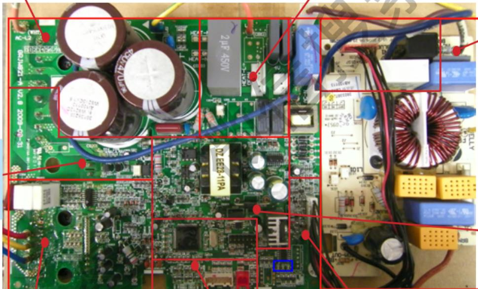
压缩机驱动电路检测点检测点：
