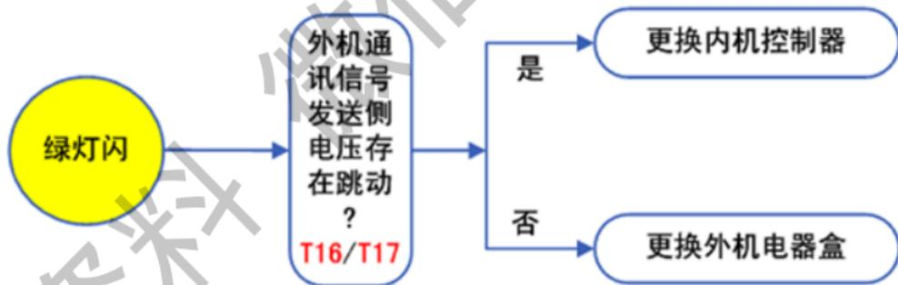
**技巧：**三个灯中任何一个灯常亮说明外机主芯片故障；绿灯闪说明外机收到了内机发送信号，但内机没收到外机返回信号，可能为外机发送或内机接收问题。不能仅简单根据指示灯的闪或灭来判断故障。
