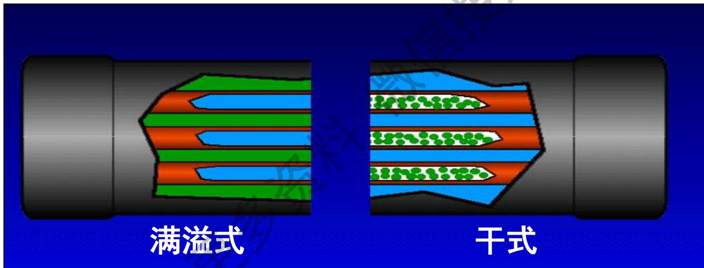
换热铜管完全浸润在制冷剂液体中，换热效果更好
