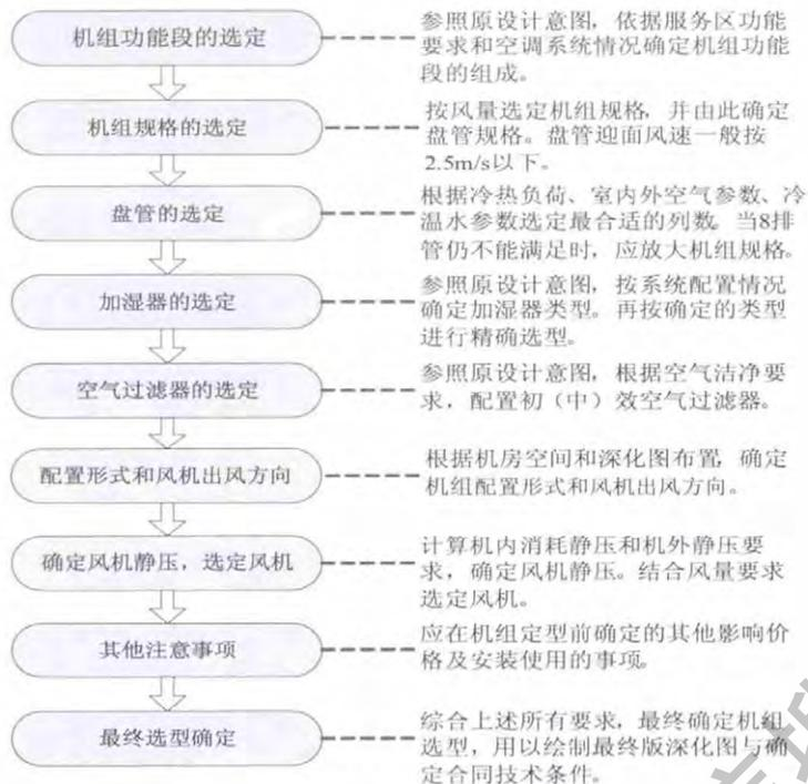
图1 机组选型流程图
