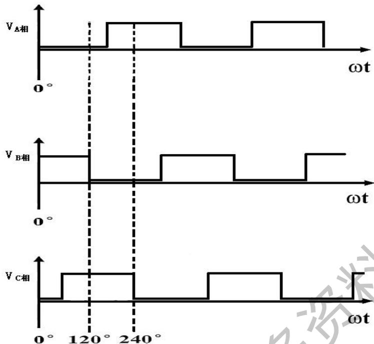
从原理图上可以看到，需检测的电源是采用三相四线制方式，每一相的电压（A、B、C相和零线之间电压，220VAC）通过4007二极管和68K大功率电阻加到PC817光耦上，在正半周期光耦导通，负半周期则光耦截止；由于光耦输出端有上拉电阻，故光耦导通时芯片检测到低电平，光耦截止时芯片检测到高电平。A、B、C三相电的相差是 $120^\circ$ ，芯片检测到A、B、C三相的波形如左图示。
