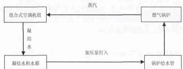
图4 组合式空调机组凝结水再利用流程图
