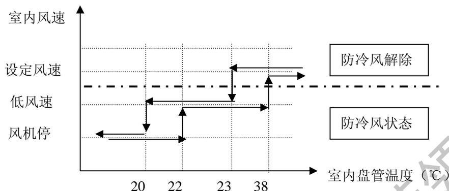
当室内盘管温度上升时，大于 22°C 低风速，大于 38°C 按设定风速运行或按自动风速运行，防冷风解除；当室内盘管温度下降时，小于等于 23°C 低风速，小于 20°C 室内风机停。防冷风时，无论设定状态如何，上下风门叶片都强制固定于最上一档位置，直到防冷风解除。除霜时室内风机按防冷风处理。
