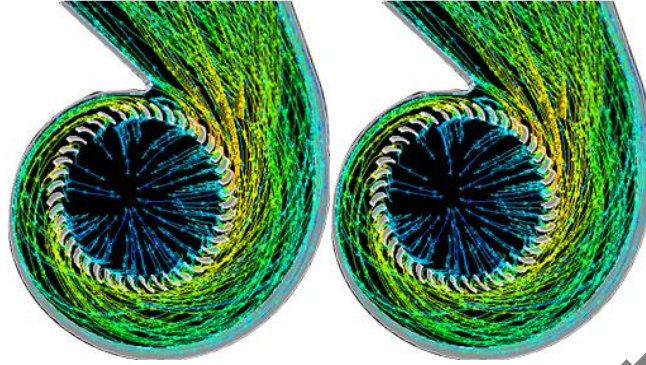
双风轮蜗壳系统并联直吹型风道 CFD解析示意图
