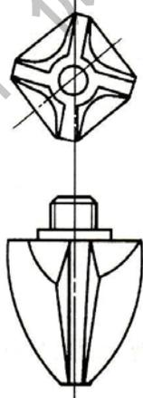
图 3-88 清除管内水垢用的刮刀
