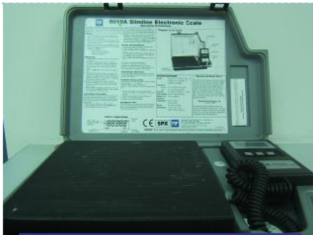
冷媒电子称(量程50kg)
