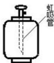
图 2-10 制冷剂钢瓶(带虹吸管)
