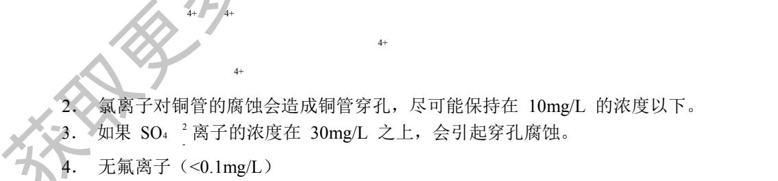
2. 氯离子对铜管的腐蚀会造成铜管穿孔, 尽可能保持在 10mg/L 的浓度以下。
