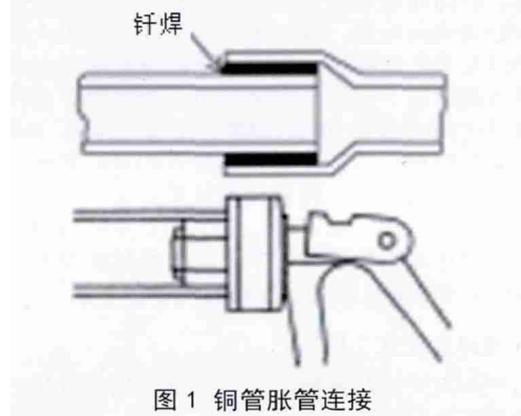
图1 铜管胀管连接
