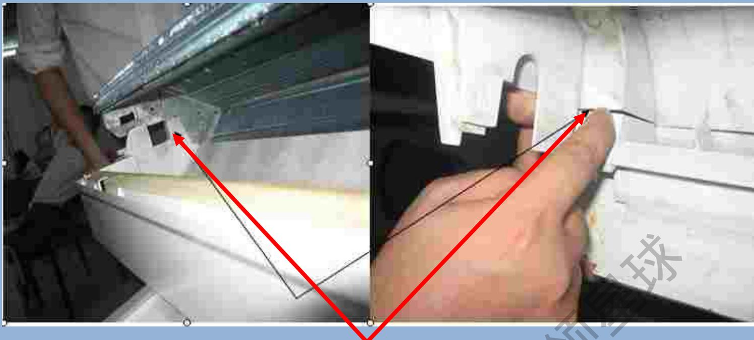
蒸发器左右端板与底座上的风轮轴承座相接触，当端板上布满冷凝水珠时，水珠势必顺着轴承座内面流到底座与出风主体之间的间隙内，从而形成漏水。
