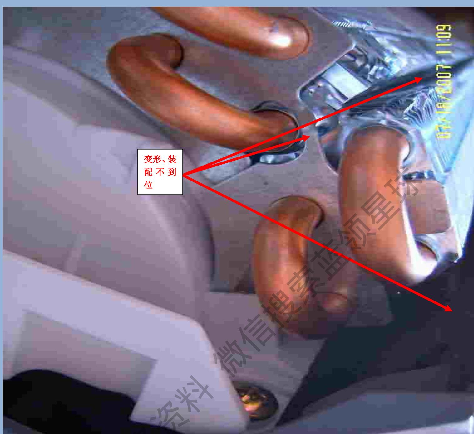
2、蒸发器装配不到位，导致漏水。
