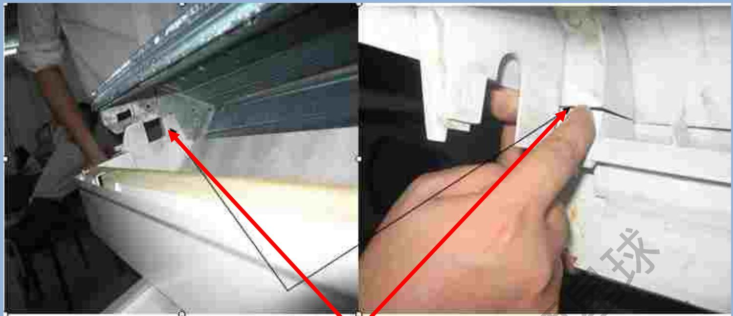
蒸发器左右端板与底座上的风轮轴承座相接触，当端板上布满冷凝水珠时，水珠势必顺着轴承座内面流到底座与出风主体之间的间隙内，从而形成漏水。
