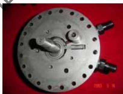
图 6-49 滚动活塞膨胀机气缸部分实物图
