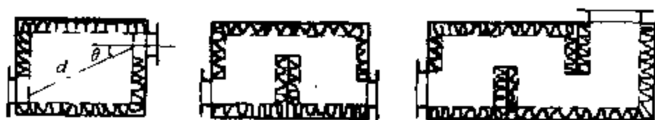
图 1-44 小室式消声器的基本形式 注: 小室内气流速度宜 \leq 5m/s
