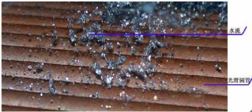
图 4-3 喷嘴 A 布水效果
