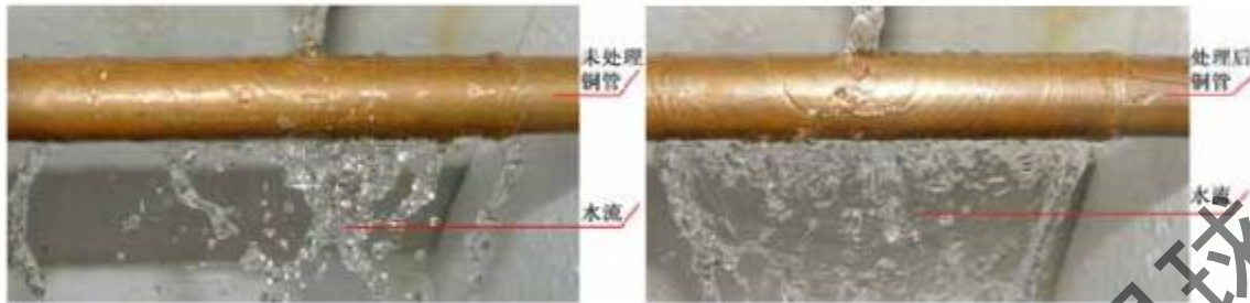
图 4-10 未处理铜管水膜分布
