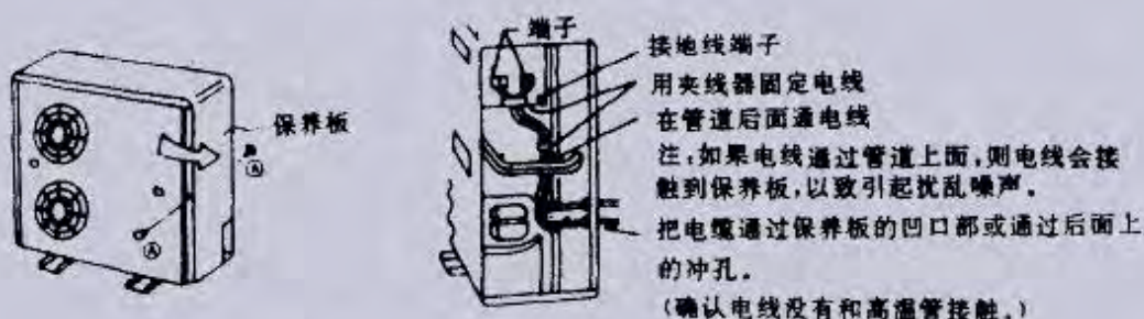
图 3-2-13 室外机组接线(4G6,5G6,6G6)
