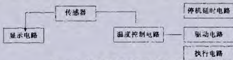
图1-6-6 电子温控器工作原理方框图
