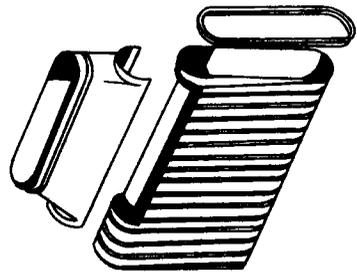
图 1-60 椭圆形风管外形示意图
