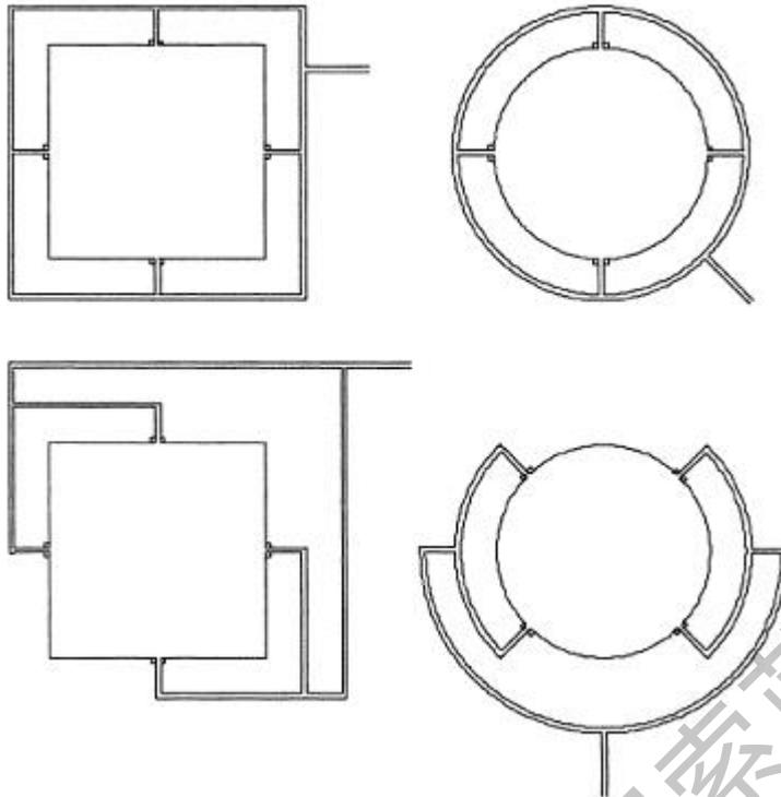
图 1. 增设静压管的结构。上面两张图展示了完全环、四对一式结构。下面两张图展示了T型结构。
