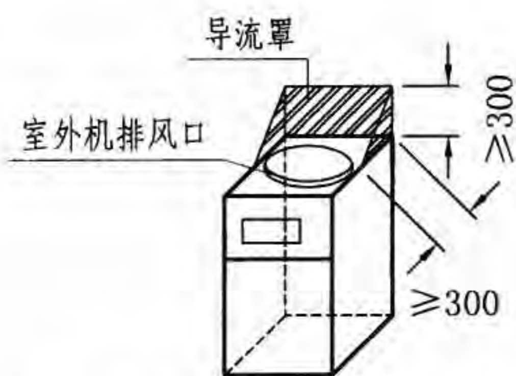
室外机安装导流风帽示意图
