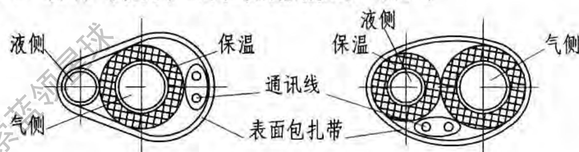
附图1 气液侧间隔热做法
