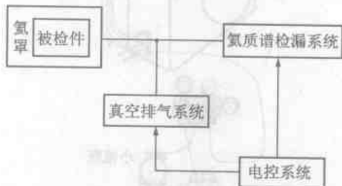
图 5.55 氦气真空检漏装置原理图
