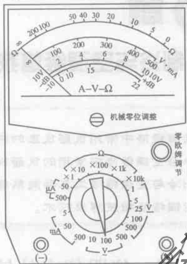
图 5.1 MF-27 型指针式万用表外形图
