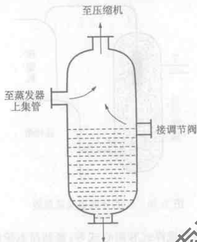
图 3.62 气液分离器结构图
