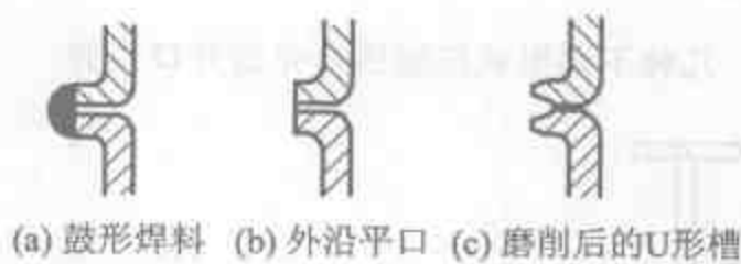
图 7.12 对焊式压缩机的接口位置
