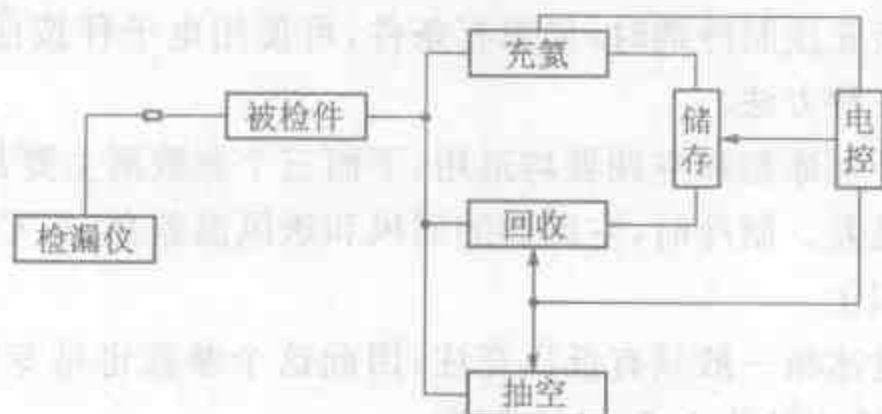
图 5.56 充氮回收检漏装置
