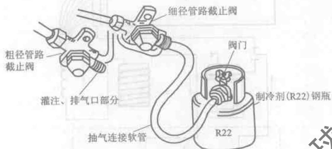
图 5.62 小氟瓶排空操作示意图(二)
