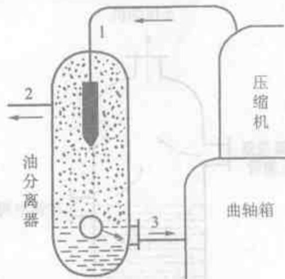
图 3.60 气油分离器安装位置
