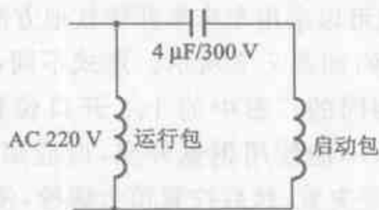
图 7.6 单相电机改为双相电机示意图
