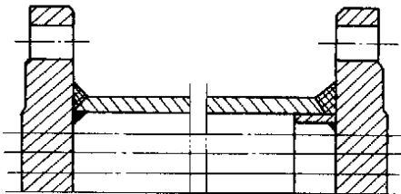
图 1-6-16 DN > 600\text{mm} 时管板与壳体的焊接型式
