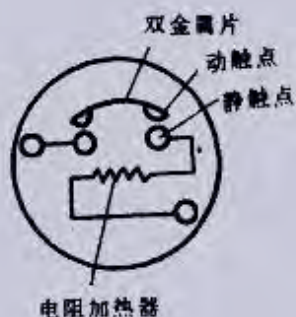
图 1-4-2 碟型热保护器构造示意图
