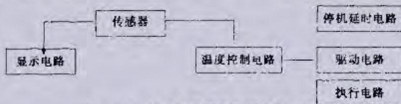
图1-6-6 电子温控器工作原理方框图
