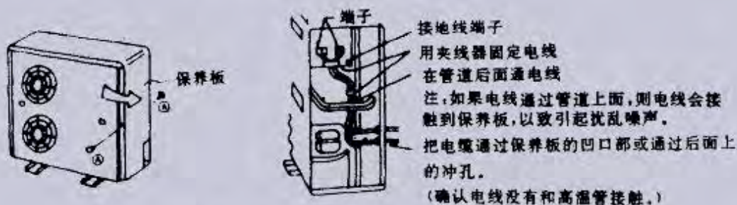
图 3-2-13 室外机组接线(4G6,5G6,6G6)
