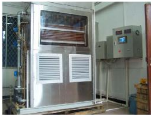
a) 蒸发式冷凝制冷系统
