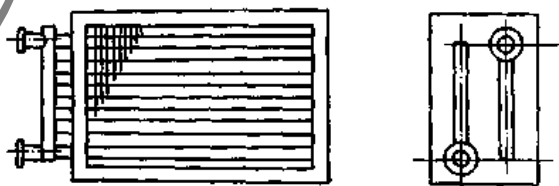
图 14-29 水冷式表面冷却器进、出口位置示意图
