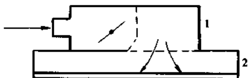
图 12-29 末端装置与风口的单连接 1-末端装置;2-送风口
