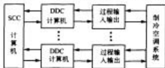
图 5-18 监督计算机控制系统的构成
