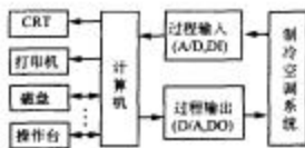
图 5-16 操作指导控制系统的构成
