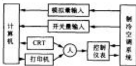
图 5-15 计算机巡回检测和数据处理系统的构成
