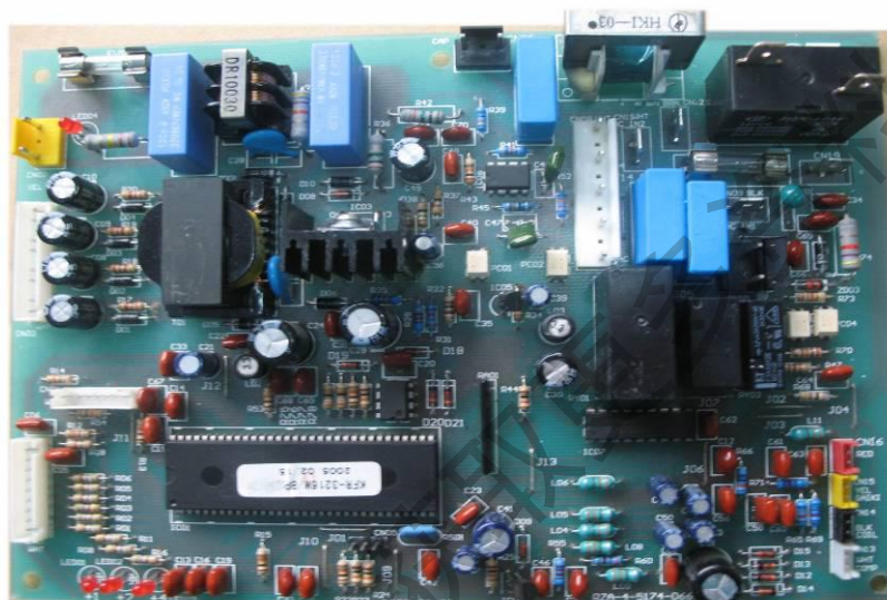
室外机控制板
