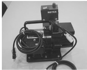
图 3-9 R410A 用 5/16in 接口 (为防止 真空泵中的机油回流, R410A 冷媒 专用真空泵必须加装电子止回阀)
