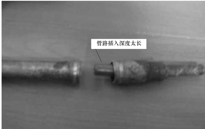
图 3-73 分歧管焊接插入深度过长示意图
