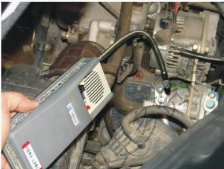
检漏仪检漏法
