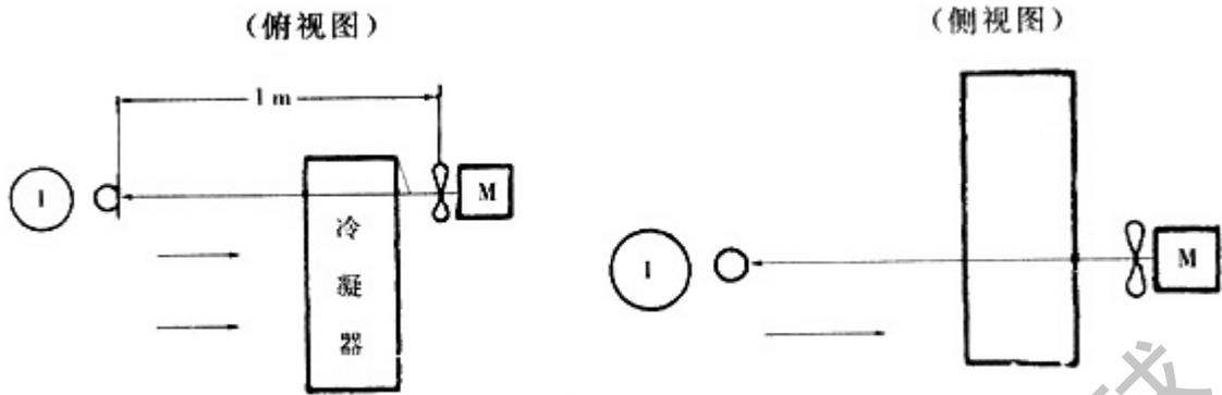
图 4 带风机冷凝器的噪声测量方法
