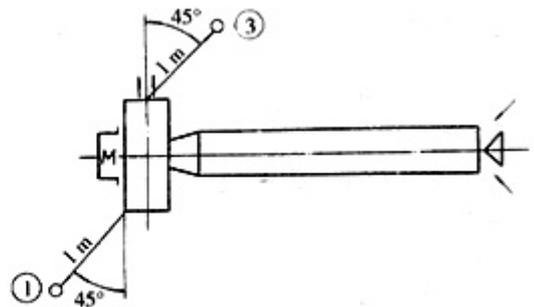
图 3 风机噪声测量方法(吸风式)
