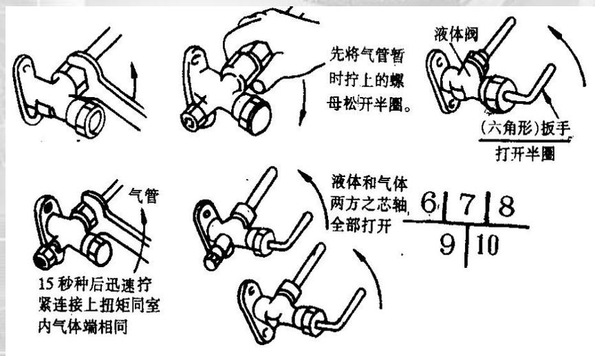
(3) 用六角形扳手拧下两个低压截止阀外的保护螺帽，见图8。当听到汽化的制冷剂泄出“嘶”声后，过15秒钟立即关闭截止阀。这时应有气体从已松开的低压气体管母处排出，等“嘶—”声渐渐消失后，重新将液体截止阀打开半圈，15秒钟后关上。这样重复2—3次，即可将室内机和管路内的空气排净，排气时间的长短，和重复操作次数，要看空调器制冷量的大小和管路长短而定。
