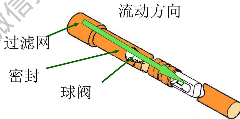
冷暖空调机中，单向阀与四通阀配合使用，用来安全有效地切换制冷剂的流向。
