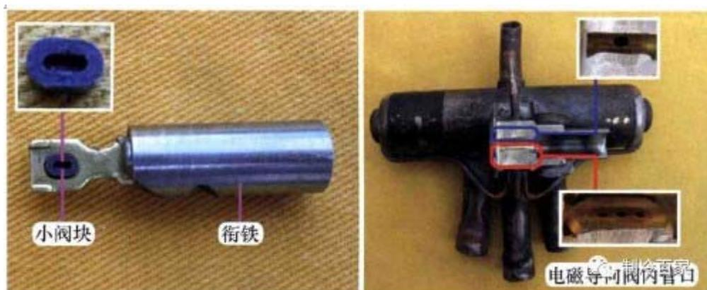
小阀块安装在衔铁上面，衔铁移动时带动小阀块移动，从而接通或断开导向阀内部下方3个管口。
