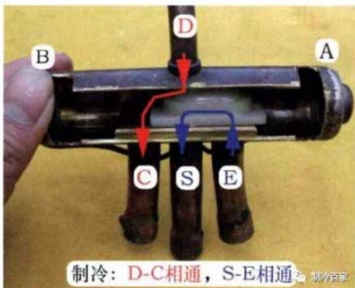
压缩机排气管 D 排出高温高压气体经 C 管口至冷凝器，三通阀 E 连接压缩机吸气管 S，空调器处于制冷状态。
