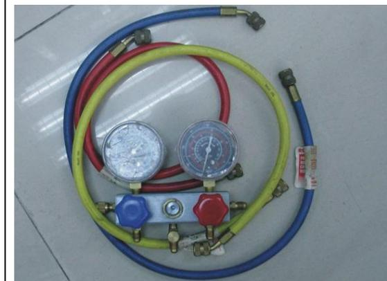
若压力表配管与冷媒罐接头没有直接匹配的话，可以使用转接头，使用规格  $\phi 12$ 、 $\phi 10$
