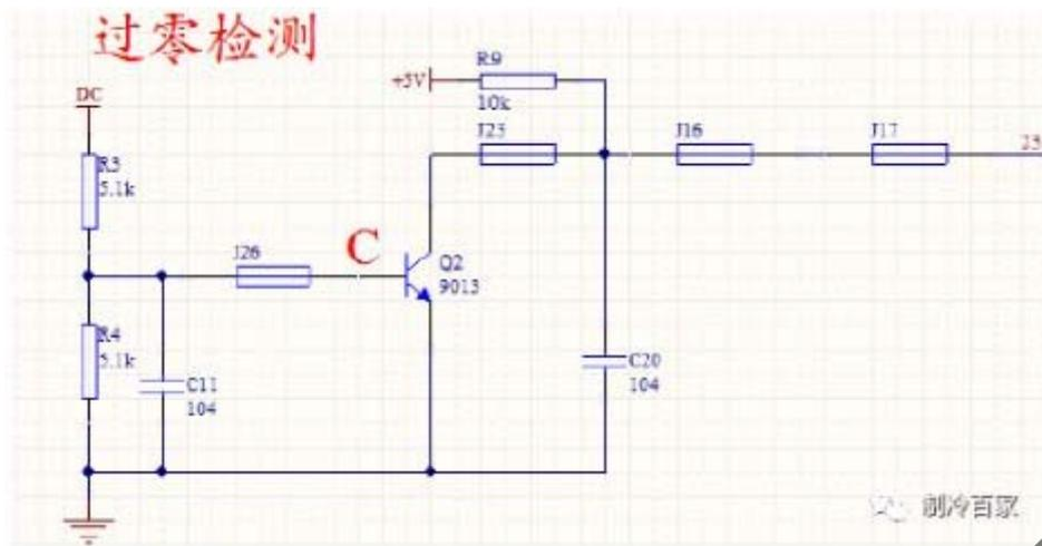
这样通过三极管的反复导通、截止，在芯片的过零引脚上就会形成 100Hz 脉冲波形，芯片通过判断，检测电压的零点。
