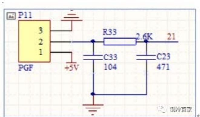
+5V 电源提供给电机内置风速检测电路使用，风机内置风速检测电路输出波形通过 R33 这个限流电阻后，通过 C33、C23 这两个瓷片电容滤波，芯片通过对输入脉冲方波频率的检测，来判断风机的转速。
