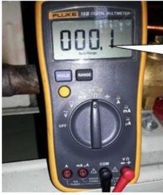
系统断电的情况下用欧姆档测量电阻，如果测出来是 $\Omega$ 则表示有短路。P, Q 之间正常的阻值是  $470K\Omega/N$ ，N 为室内机数量。室外机 P, Q 之间的阻值为  $100\Omega$ （测量阻值时断开与室内机的连接）。
