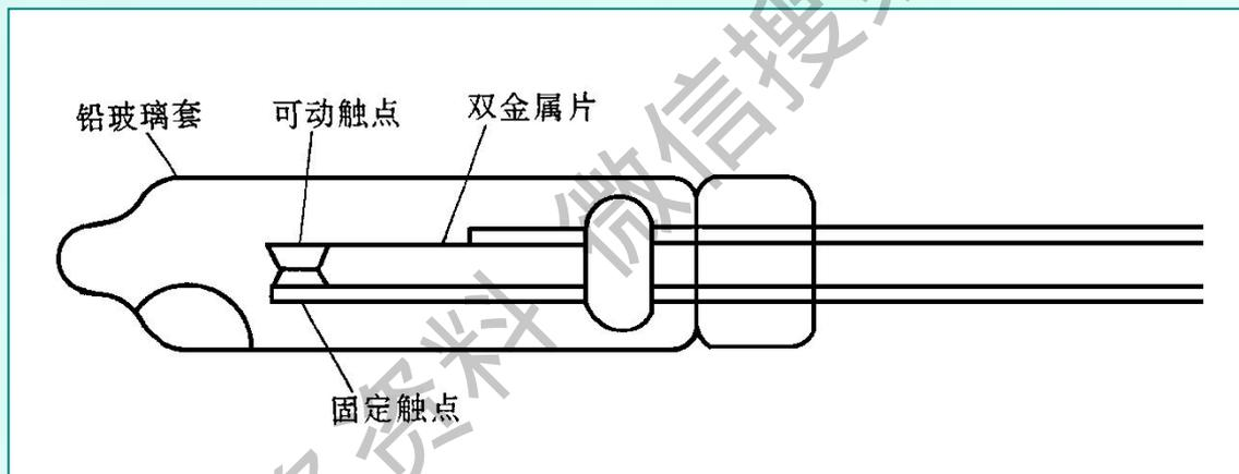
将其装在电动机的定子绕组中，直接感受电动机定子绕组内的温度变化，其工作原理与前述碟型过载保护器基本相同。
