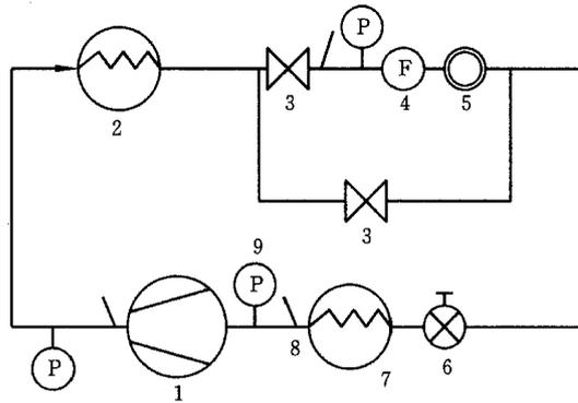
1—压缩机;2—冷凝器;3—截止阀;4—液体制冷剂流量计;
