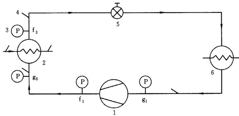
1—压缩机;2—水冷冷凝器;3—压力表;4—温度计;5—节流阀;6—蒸发器
