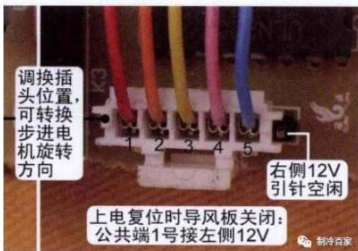
使公共端接左侧直流 12V 引针（右侧空闲），即调整 4 根驱动引线的首尾顺序，驱动顺序改为 2-3-4-5，通用板再次上电导风板复位时就会自动关闭，开机后为自动打开。
