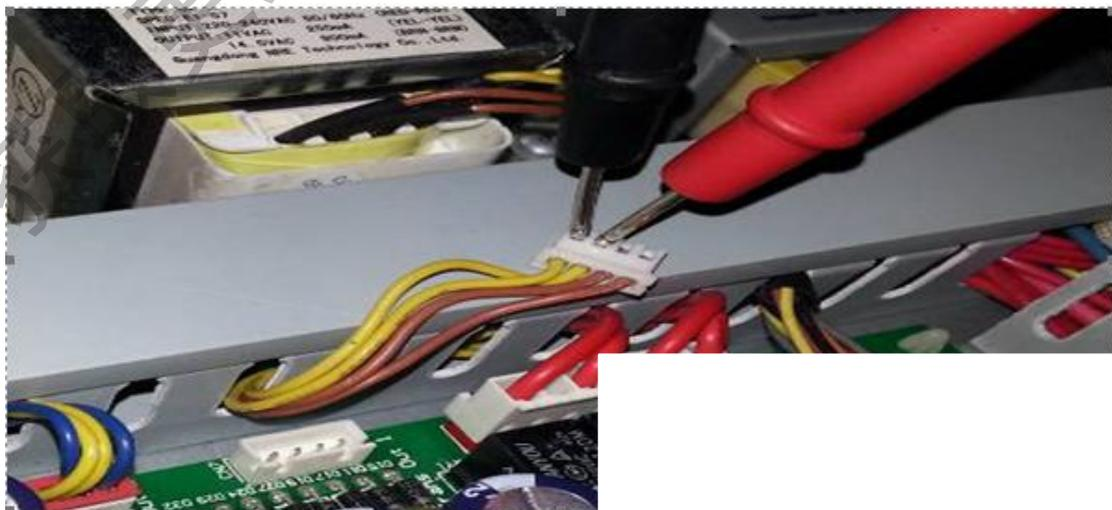
解决方案：如果测量的电压值不正常则更换变压器，否则更换主控板。
