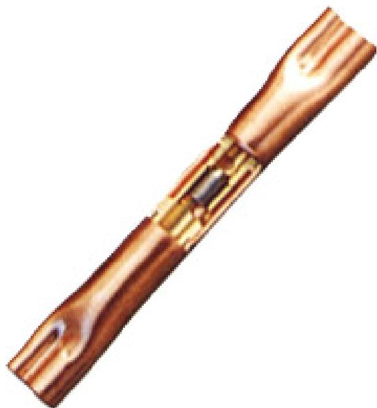
用于空调器、冷冻机等制冷设备，使系统中压缩机停止时防止高压逆流和制热时控制冷媒量，达到制热的目的。
